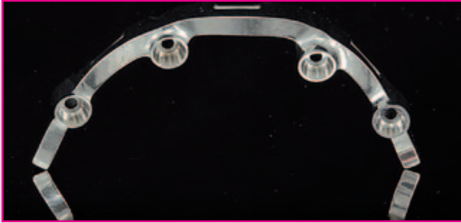
Abb. 6a-b: CAD/CAM geplante und industriell gefräste Gerüststruktur aus Titan oder Kobalt-Chrom (E.S. Healthcare, Belgien); linkes Bild: Prof. Dr. G. Gómez-Román/ZTM B. Roland, rechtes Bild: Dr. F. Kornmann/ZTM B. Roland.
