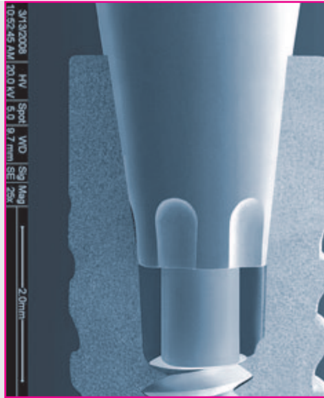
Abb. 4b: Der Konus sichert die kraftschlüssige Verbindung und den Rotationsschutz.
