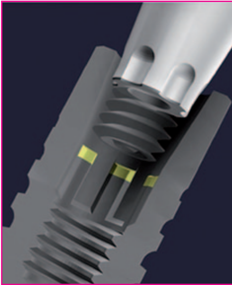
Abb. 4a: Die Richtung für die indexierten Aufbauten wird durch den internen Index vorgegeben.
